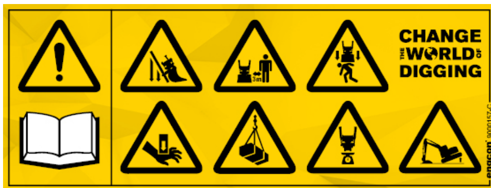
Afbeelding9. Waarschuwingsticker aan rechterzijde van de machinist.
